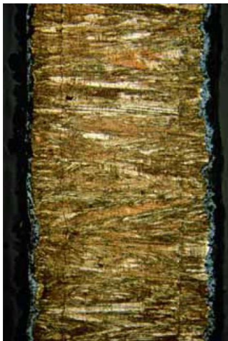
Figura 1 – Metalografia de peça produzida pela WMF, onde são observadas três camadas de depósito 10
